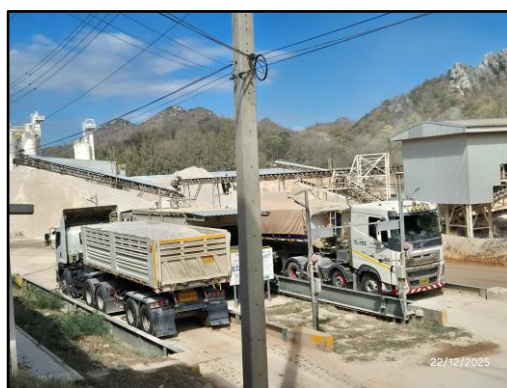
รูปที่ 2-16 การควบคุมน้ำหนักรถบรรทุกก่อนออกนอกพื้นที่โครงการ
