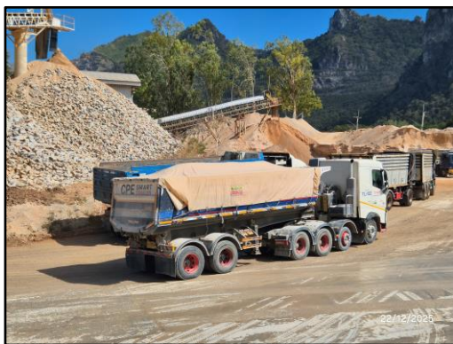
รูปที่ 2-21 การปิดปกคลุมท้ายกระบะบรรทุก
