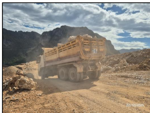
รูปที่ 2-12 การจัดเตรียมขนย้ายเศษดิน และเศษหิน ออกจากพื้นที่หน้าเหมือง และการจัดเตรียมรถฉีดพรมน้ำบริเวณที่มีกิจกรรมการขนย้าย
